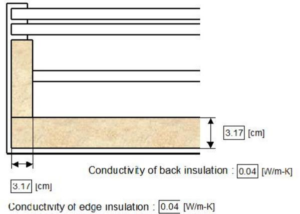
Figure 5 The Edge and back Insulation parameters
